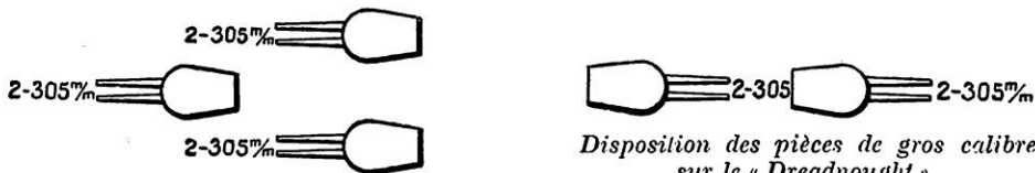
FIG. 1. — LE « DREADNOUGHT » (1906), CUIRASSÉ ANGLAIS QUI FUT LE TYPE DE TOUS LES BATIMENTS CONSTRUITS SUR LE PRINCIPE DE L'UNITÉ DE GROS CALIBRE
