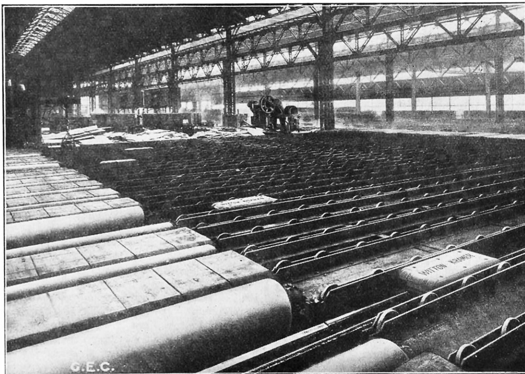
FIG. 1. — VUE GÉNÉRALE D'UN HALL OU LES PLAQUES DE TOLE, AU SORTIR DES LAMINOIRS, SONT AMENÉES A SE REFROIDIR, AVANT D'ÊTRE DÉCOUPÉES PAR LES CISAILLES
