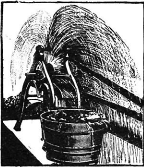
L'EAU EST PROJETÉE VIOLEMMENT A SON ARRIVÉE A LA POULIE SUPÉRIEURE PAR LA FORCE CENTRIFUGE. VUE DE L'APPAREIL. LE CARTER ENLEVÉ
