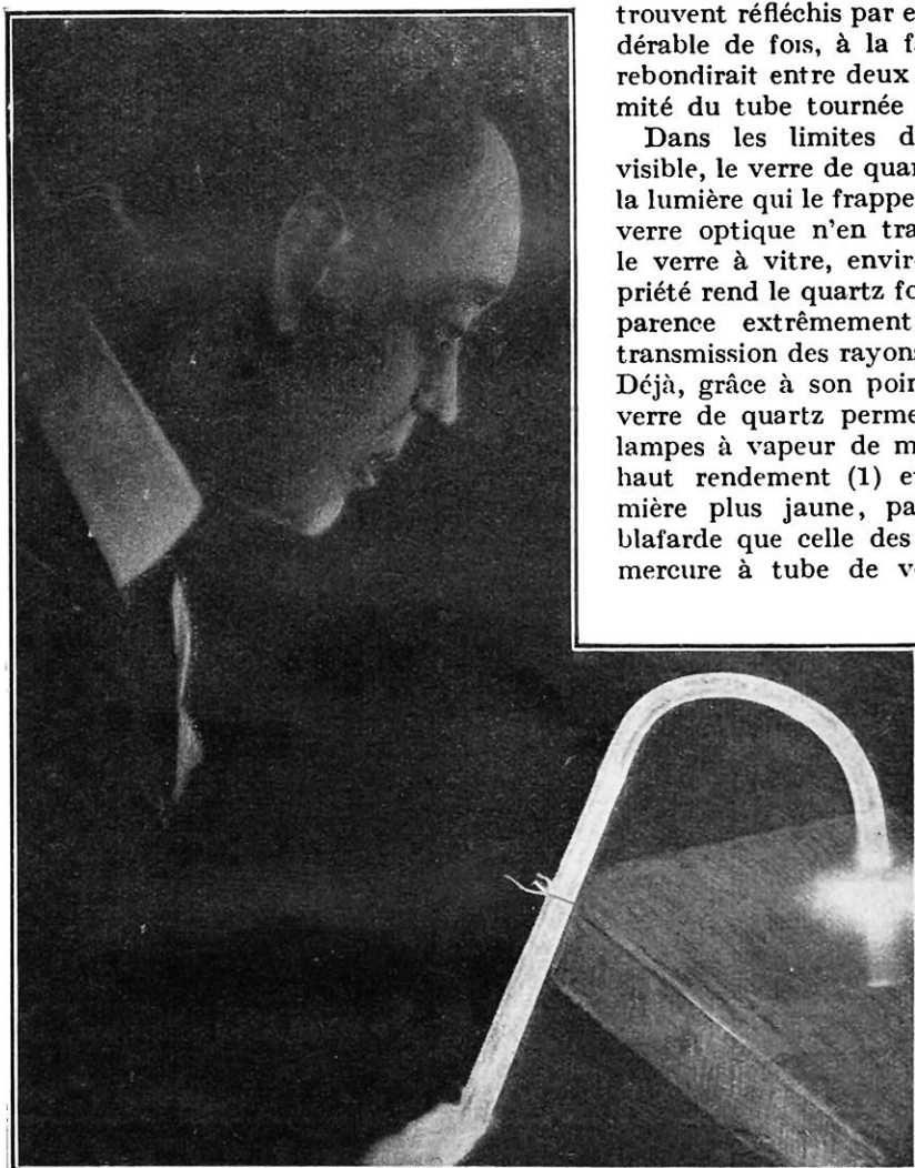
EXPÉRIENCE MONTRANT LE HAUT DEGRÉ DE TRANSPARENCE ET LE REMARQUABLE POUVOIR RÉFLECTEUR DU QUARTZ FONDU PAR LE NOUVEAU PROCÉDÉ DE M. BERRY
