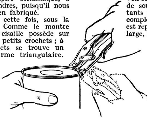
FIG. 1 — MANIÈRE D'OPÉRER POUR ENFONCER LE PERCEUR DE L'OUVRE-BOITE SOUS LE COUVERCLE
