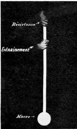
FIG. 3 (A). — A gauche, avec l'emplacement des mains des deux opérateurs (le premier opérateur tient la canne, le second est chargé de son entraînement); à droite, schéma d'un exemple de réalisation d'un transformateur Constantinesco au moyen d'une bielle motrice reliée au milieu d'un levier intermédiaire oscillant, dont l'extrémité inférieure s'articule sur un long levier pendulaire, soutenu, à la partie supérieure, par une chape et lesté, à son autre extrémité, par une masse de poids déterminé. A l'extrémité supérieure du levier intermédiaire s'articulent deux biellettes de renvoi,
