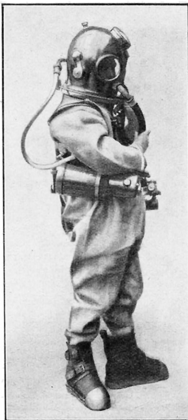
FIG. 1. — LE SCAPHANDRE BOUTAN On voit la bouteille d'air sous le bras de l'homme ; il tient dans sa main droite le tuyau d'évacuation d'air vicié ; derrière son casque, le tuyau d'air.
