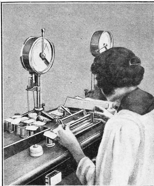
FIG. 9. — PRÉPARATION DU FIL DE TUNGSTÈNE TERMINÉ POUR LES ESSAIS A LA BALANCE DE TORSION
