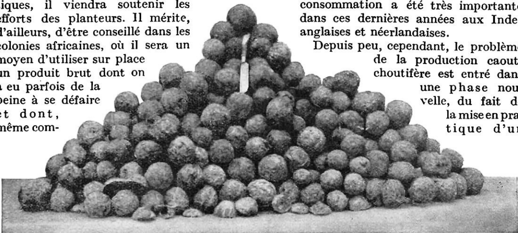
BALLES DE CAOUTCHOUC. QUI SERONT PLUS TARD AGGLOMÉRÉES PAR SIMPLE PRESSION
