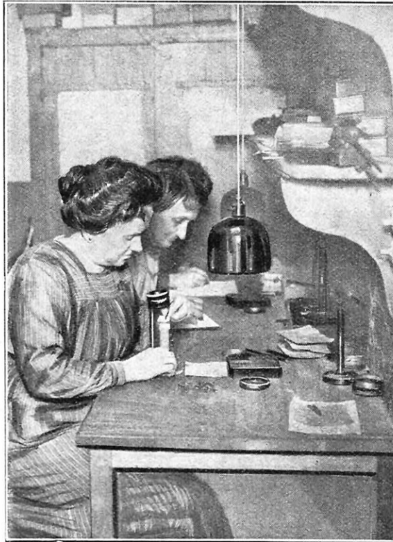
PREMIÈRE OPÉRATION DU CONTRÔLE L'ouvrière examine une à une les plumes à la loupe et rejette celles qui sont défectueuses.
