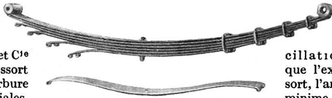
MONTAGE D'UN RESSORT ISOSTATIQUE Au-dessous, une lame avec ses courbures spéciales ; au-dessus, les lames bouclées d'un côté, encore libres de l'autre.
