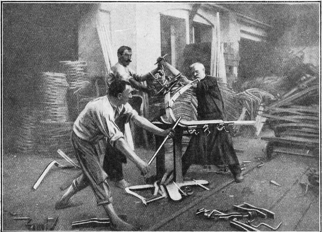
COURBURE DU BOIS, LÉGÈREMENT AMOLLI, APRÈS SA SORTIE DES FOURS
