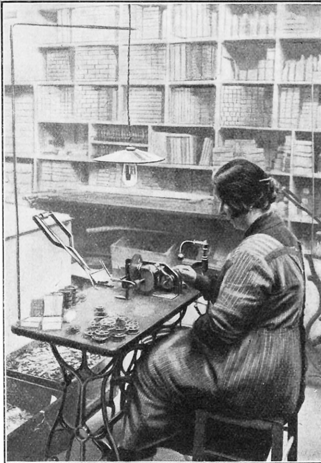
MACHINE POUR LE BOBINAGE DU RUBAN ENCRÉ, LA FORMATION D'UNE BOUCLE A L'UNE DE SES EXTRÉMITÉS ET LA POSE D'UNE AGRAFE A L'AUTRE, POUR SA FIXATION SUR LA MACHINE A ÉCRIRE
