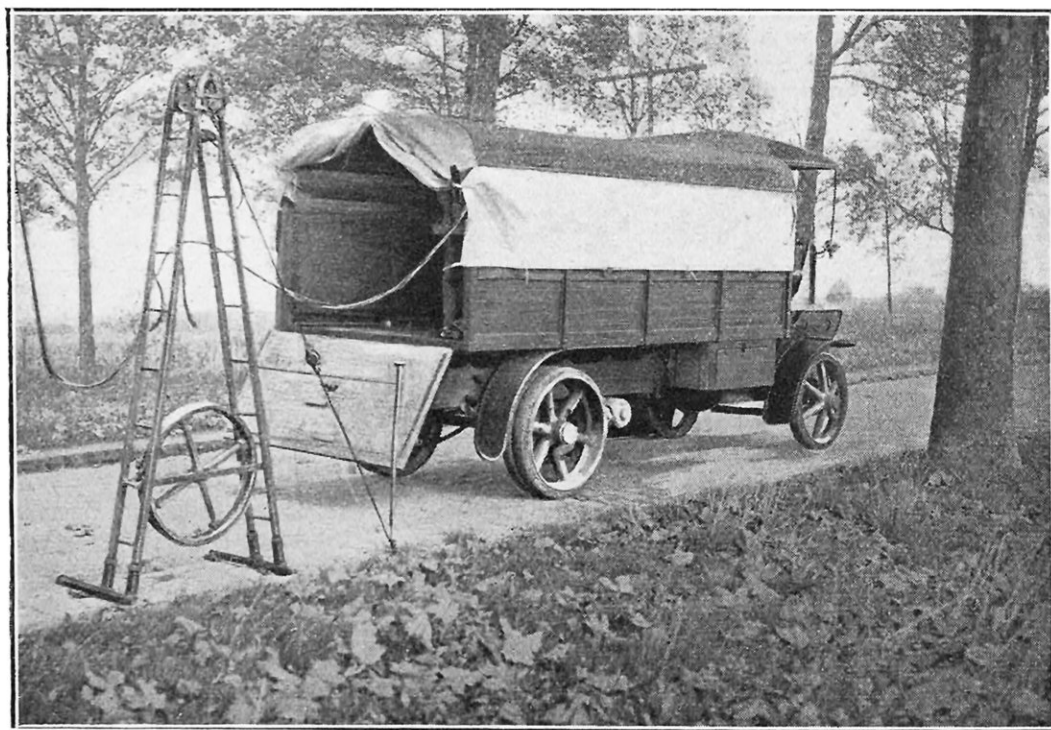
FIG. 5. — LES MACHINES SONT ALIMENTÉES PAR UN GROUPE ÉLECTROGÈNE SUR CAMION Le courant électrique est transmis le long de la route au moyen d'une canalisation supportée par des échelles isolantes doubles et pouvant être montée et démontée très rapidement.
