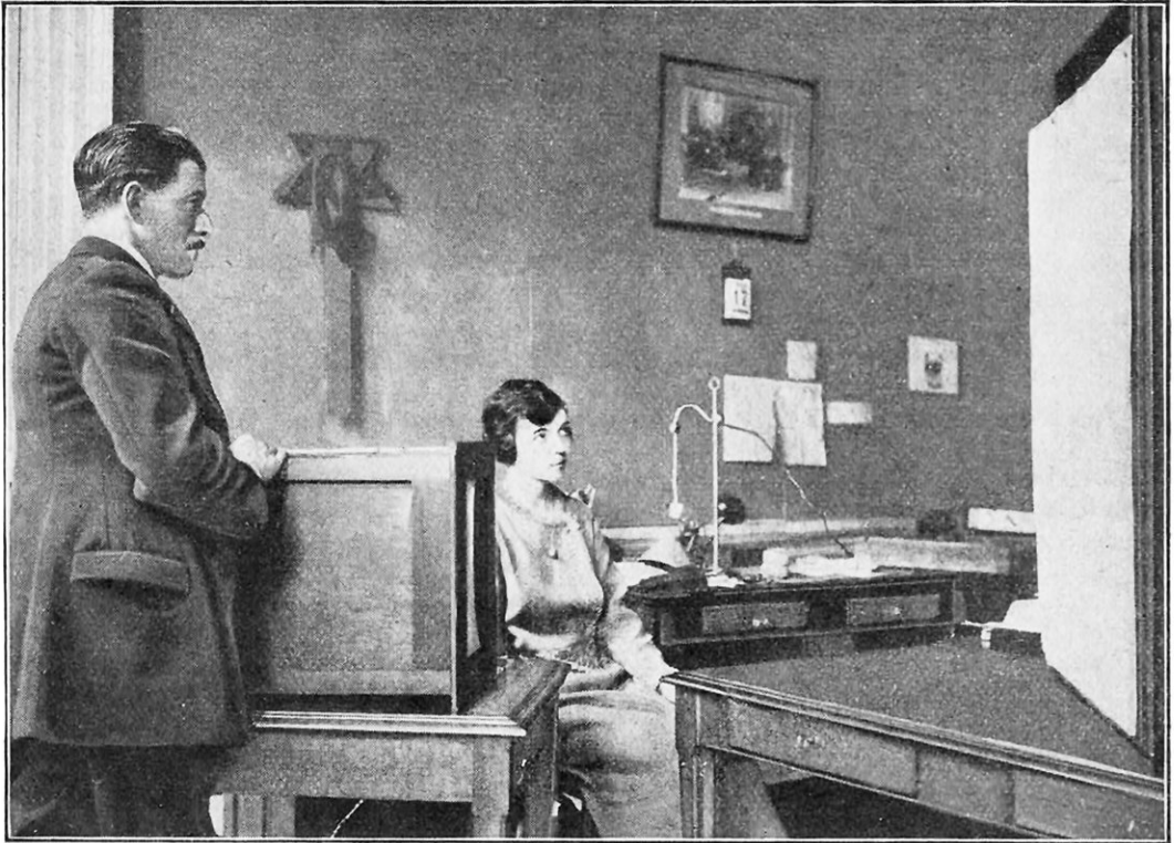
EN PLAÇANT LA MACHINE A LIRE HORIZONTALEMENT ET EN RETIRANT LA VITRE DÉPOLIE, L'IMAGE SE PROJETTE AU LOIN SUR LE MUR OU SUR UN ÉCRAN
