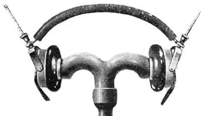
FIG. 2. — LE HAUT-PARLEUR CONSTRUIT AVEC DEUX ÉCOUTEURS
