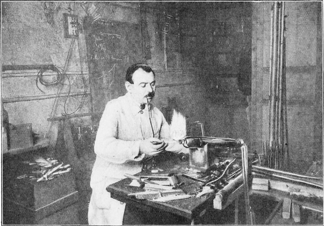
FIG. 4. — FERMETURE AU CHALUMEAU DE L'UNE DES EXTRÉMITÉS D'UN GROS TUBE APRÈS LA MISE EN PLACE DE L'ÉLECTRODE MÉTALLIQUE
