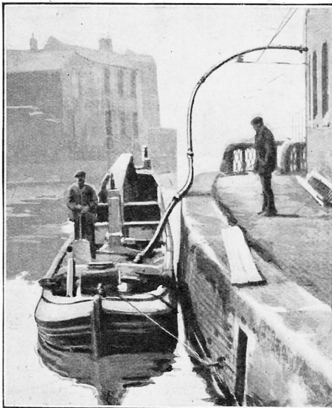
LE DECHARGEMENT ET LE TRANSPORT A L'USINE DU CHARBON PULVÉRISÉ SONT AUTOMATIQUES
