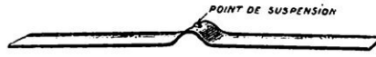
FIG. 3. — Le centre de gravité est plus bas que le point de suspension.
