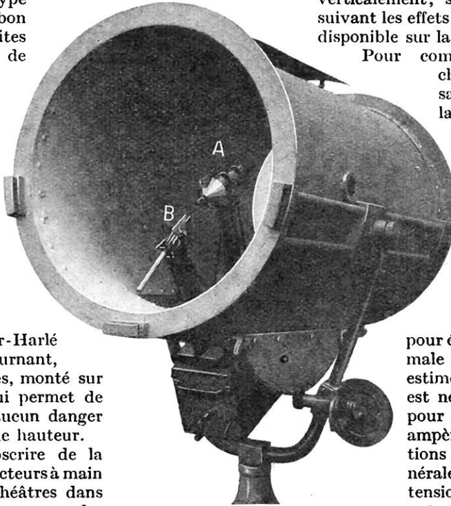
FIG. 7. — PROJECTEUR SAUTTER-HARLÉ MONTÉ SUR PIED MOBILE. Cet appareil est vu de l'arrière, le miroir enlevé. On voit au fond le charbon positif A qui, outre son mouvement d'avancement, tourne constamment sur lui-même. Le dispositif conique visible autour du charbon sert au refroidissement. En avant se trouve le charbon négatif B, simplement muni d'un dispositif d'avancement.
