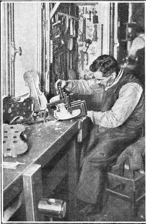
LA POSE DE LA BARRE INTÉRIEURE
