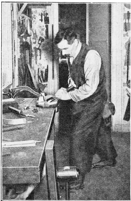
L'ÉBAUCHAGE DE LA TABLE A LA GOUGE Sur les deux faces, on enlève des épaisseurs de bois pour obtenir la « voûte » désirée.
