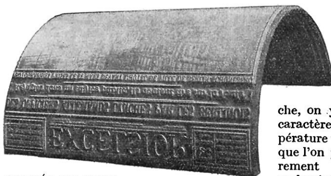
CLICHÉS CYLINDRIQUES POUR IMPRESSION SUR MACHINES ROTATIVES A GRAND TIRAGE
