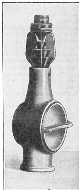
INJECTEUR A TROIS CÔNES Cet injecteur sert à quintupler dans les flotteurs le volume d'air contenu dans la bouteille.
