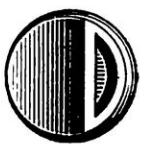
SIFFLET A BOUCHE Vue en coupe et en bout.
