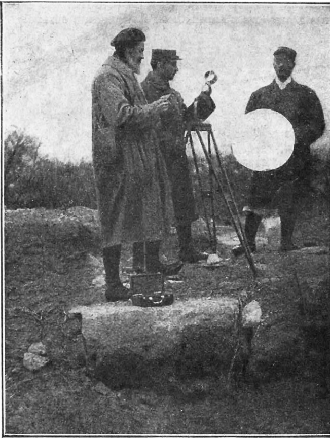
ON PEUT ENCORE DÉTERMINER LA DIRECTION DES VENTS PAR LA MARCHÉ DES NUAGES, AU MOYEN DE L'ÉQUERRE OU RAPPORTEUR CÉLESTE
