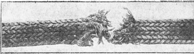
CABLE D'ALOËS ROMPU PAR LA MACHINE BUCKTON La rupture a eu lieu sous une charge de 30.000 kilos.
