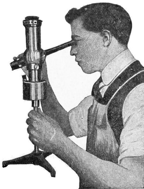
LUNETTE PYROMÉTRIQUE A MAIN ET A VISION DIRECTE POUR ATELIER
