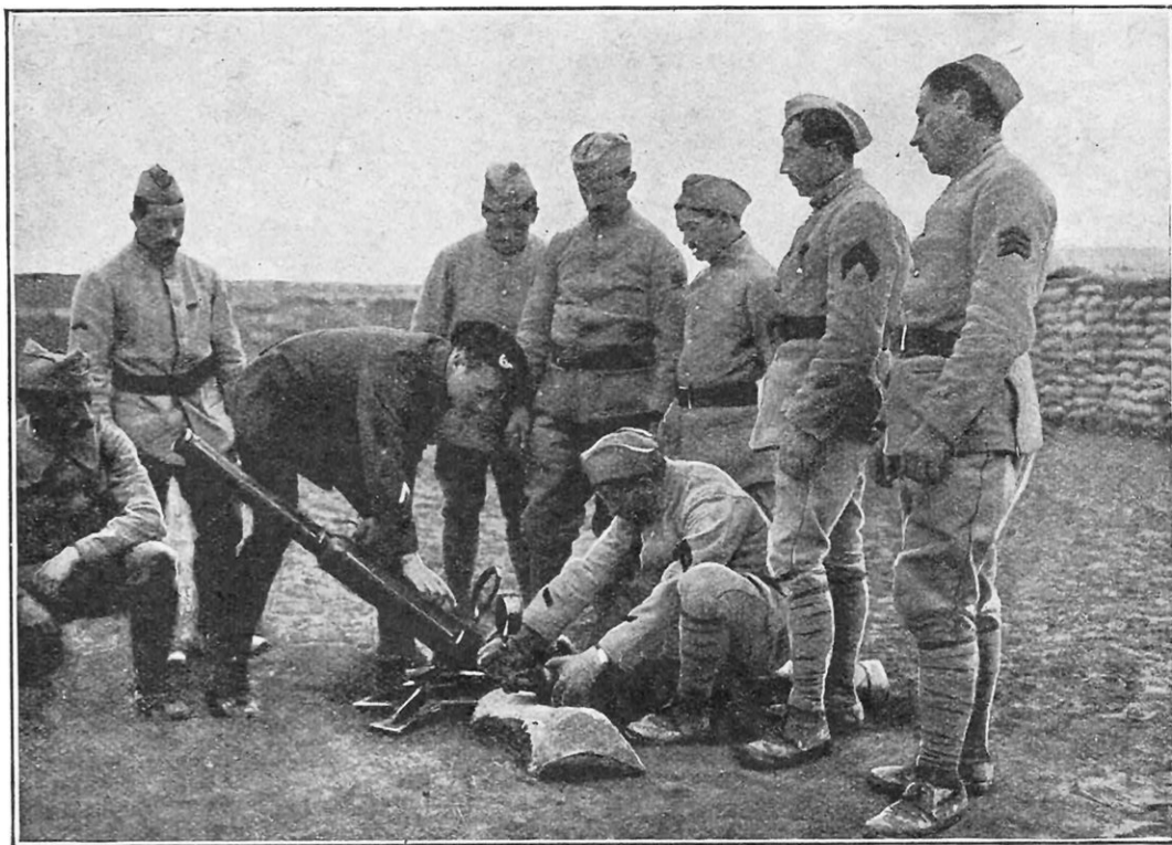
L'INTRODUCTION DE L'AIR COMPRIMÉ DANS LE MORTIER PNEUMATIQUE
