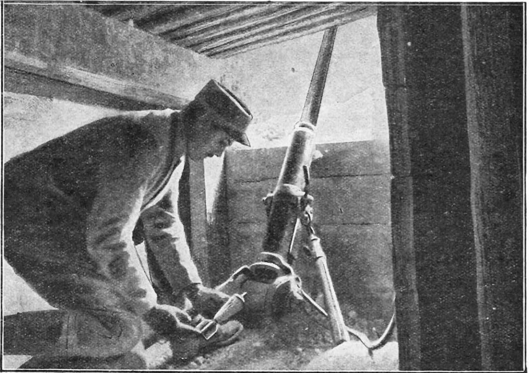
LE MORTIER-PNEUMATIQUE EST CHARGÉ AVEC UN PROJECTILE A AILETTES On voit ici l'engin en batterie dans un ancien abri blindé de mitrailleuse, sur le front de Champagne.
