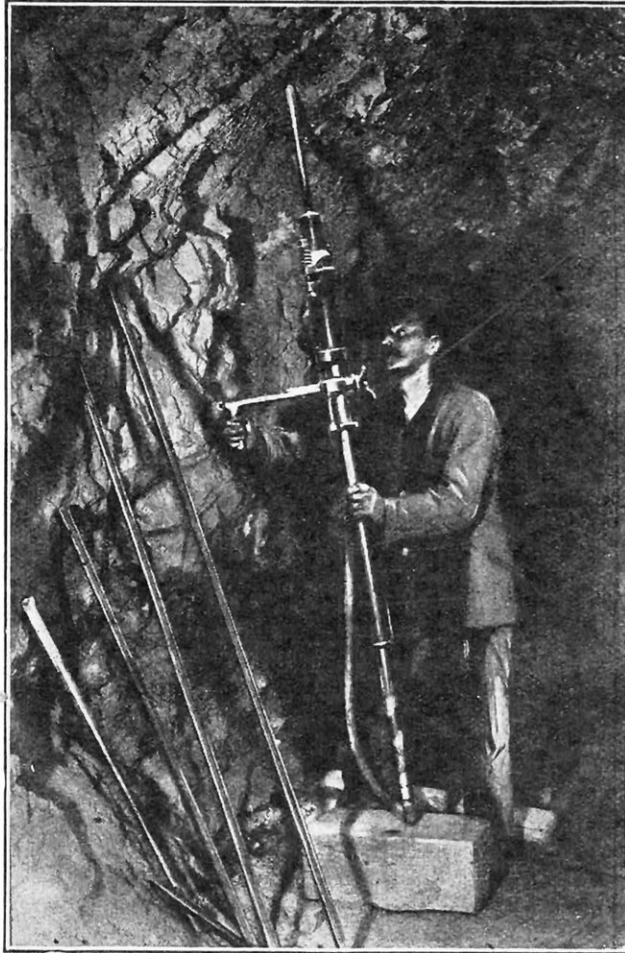
PERCEMENT D'UN TROU DE MINE DANS LE TOIT D'UNE CHAMBRE AU MOYEN DU MARTEAU PNEUMATIQUE
