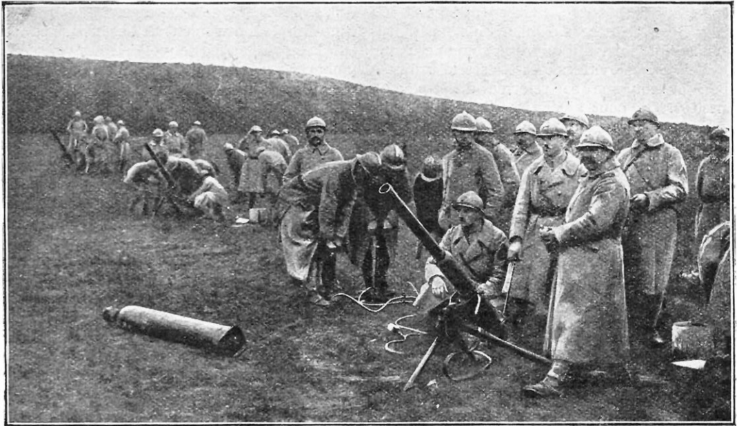
MORTIERS PNEUMATIQUES LANCE-BOMBES, SUR TRÉPIED, EN POSITION DE TIR Au premier plan de la photographie, on voit, sur le sol, un tube-réservoir d'air comprimé.
