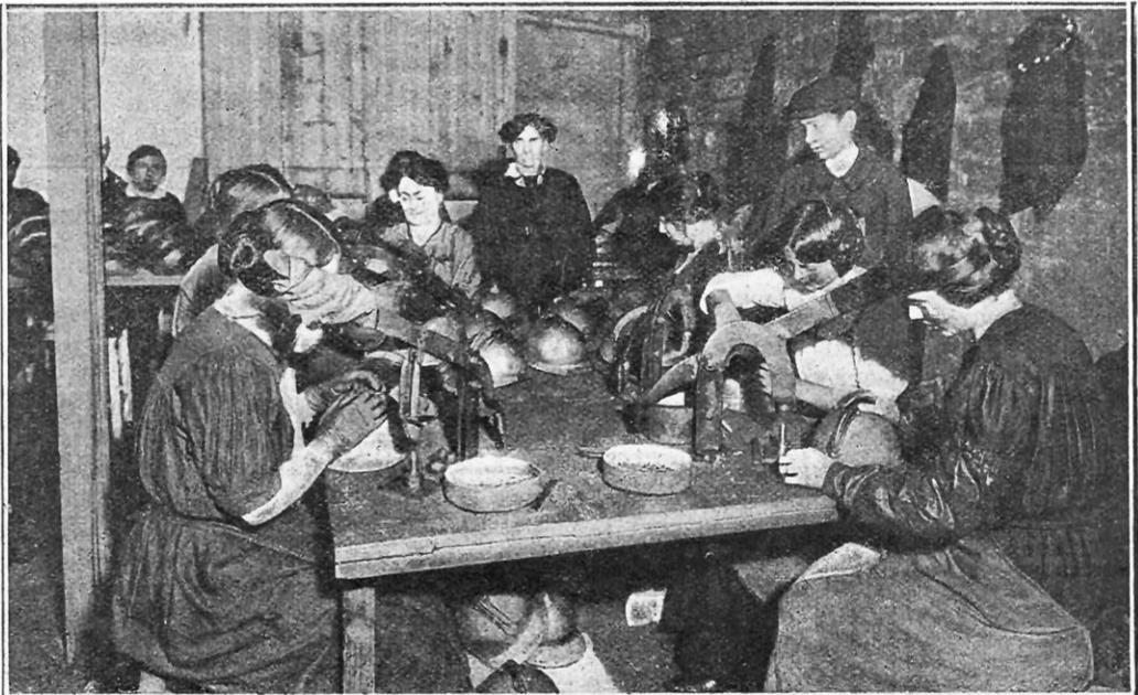
RIVETAGE DU CIMIER SUR LA BOMBE AU MOYEN DE QUATRE RIVETS D'ALUMINIUM.
