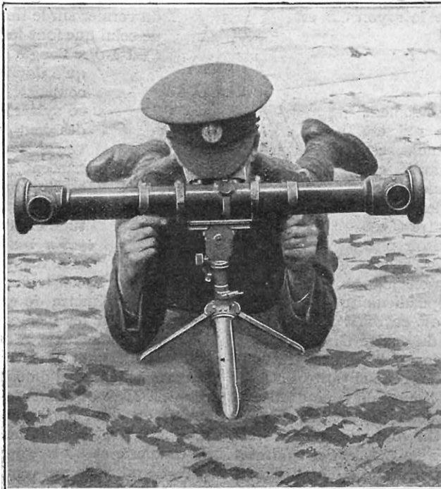
MOYEN SÛR POUR TÉLÉMÉTRER EN TERRAIN DÉCOUVERT
