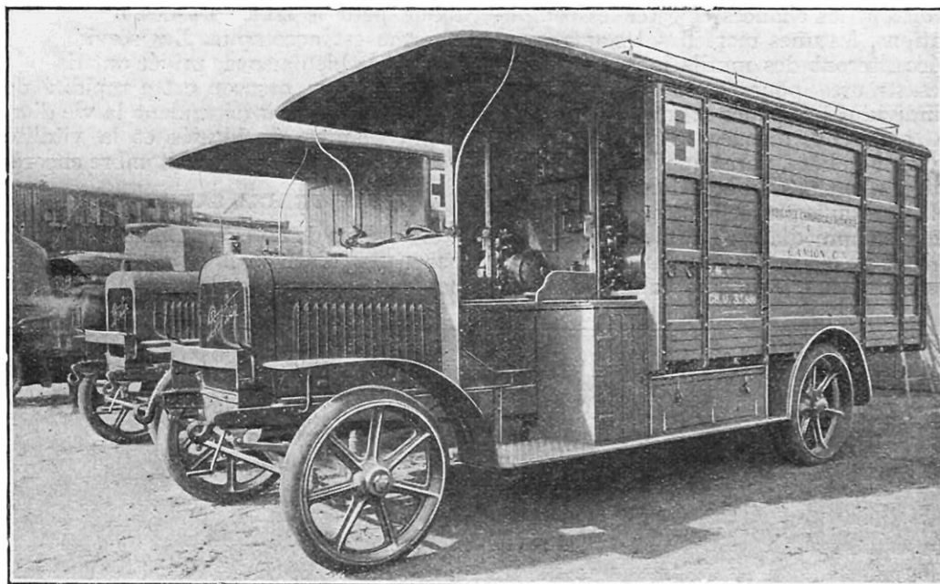
LES TROIS CAMIONS CONSTITUANT L'AMBULANCE CHIRURGICALE AUTOMOBILE MARCILLE Le camion figurant au premier plan de la photographie renferme les groupes électrogènes, pour l'éclairage de l'ambulance, et tout le matériel chirurgical nécessaire aux opérations.
