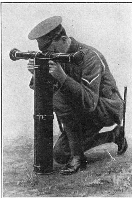
LA POSITION A GENOUX DU TÉLÉMÉTRISTE L'étui du télémètre de campagne peut former, comme on le voit, un pied très stable pour l'instrument.
