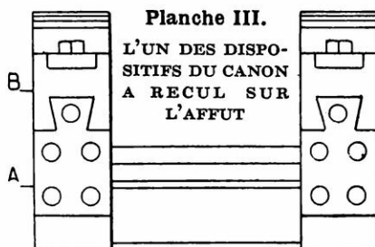
Planche III. L'UN DES DISPOSITIFS DU CANON A RECU SUR L'AFFUT A, glissières ; B, patins porte-tourillons à queue d'aronde glissant sur les glissières et venant, à l'aide d'un piston, comprimer un ressort puissant disposé dans un cylindre relié à l'affût qui reste fixe.
