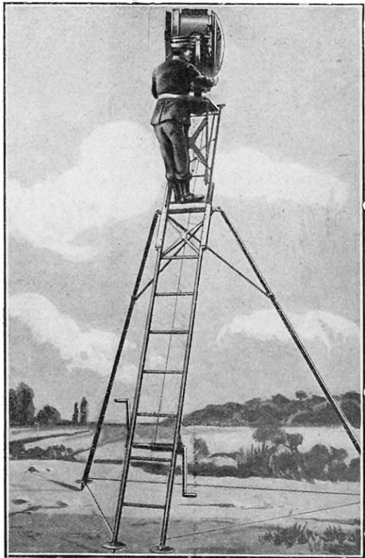
PROJECTEUR DE 60 cm SYSTÈME SAUTTER-HARLÉ, EMPLOYÉ DANS L'ARMÉE FRANÇAISE
