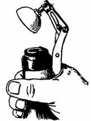
levier et provoque instantanément l'ouverture ; le bouchon se ferme automatiquement dès que la main abandonne le levier.
